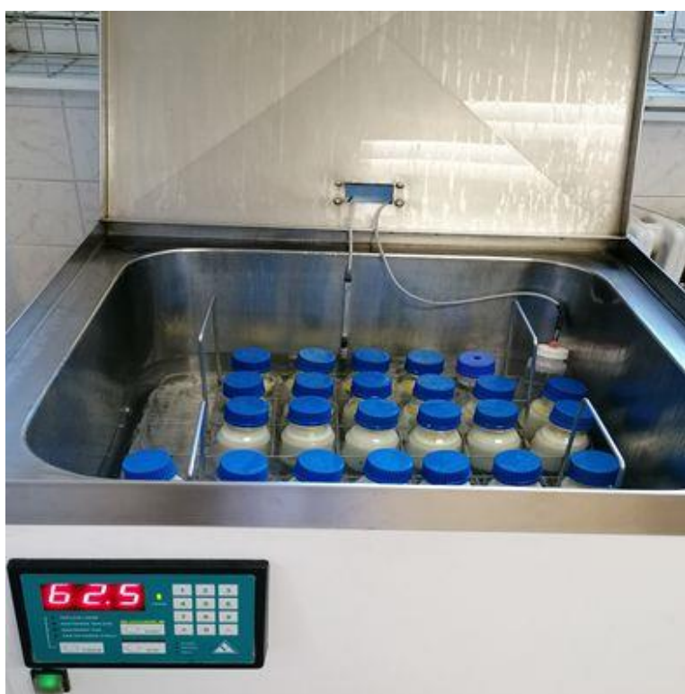
Holderova pasteurace mateřského mléka při T=62.5^{\circ}\text{C} po dobu 30 minut
